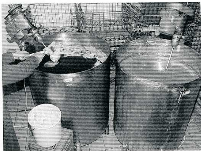
❸ Introduisez dans le miel liquide maintenu à 14 °C environ 5 % de miel brassé et mélangez l'ensemble. Le seau de droite montre le résultat.
