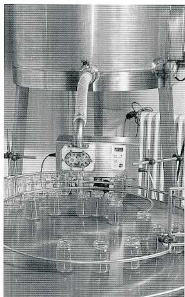
• Une table tournante avec une simple pompe-doseuse, réglable selon la contenance des pots, constitue un matériel de base qui simplifie la tâche.
